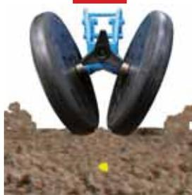
Задний прикатывающий блок, состоящий из двух V-образных колес, закрывают борозду вокруг семени для оптимального их прорастания.
