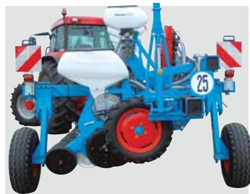
Транспортная тележка (продольная) доступна для сеялок различной конфигурации. Данная транспортная тележка может подниматься вручную или гидравлически.
