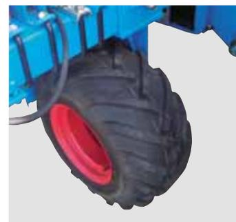
Широкие колеса большого диаметра гарантируют постоянный привод высевальных аппаратов. Быстрая расстановка по ширине приводных колес означает быструю расстановку для трактора с различной колеей.
