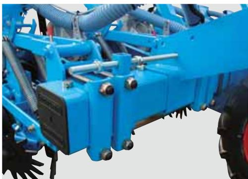
Стопорные части на телескопической системе позволяют регулирование отлично подходящее для требуемого междурядья и складывание, которое подходит для оборудования сеялки.
