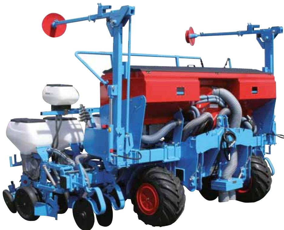
6-рядная сеялка Monoblock2 Comfort с устройством для внесения удобрений 680 л и системой Microset
