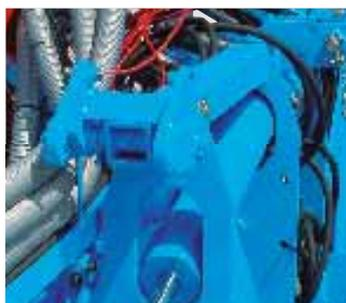
Крайние балки автоматически защелкиваются в транспортном положении. Это осуществляется непосредственно из кабины трактора.
