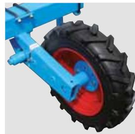
Стандартный колесный блок с колесом 6,5x80x15
