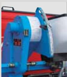
Система Microsem регулируется с помощью MicroDrive™, легко доступной с боку сеялки для быстрой и простой настройки требуемой дозы внесения. Эта трансмиссия также оборудована размыкающим механизмом, который останавливает систему Microsem когда это необходимо.
