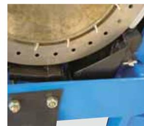
Датчики контроллеров посева размещены под высевающим аппаратом. Луч света контролирует прохождение семян, даже самых маленьких.
