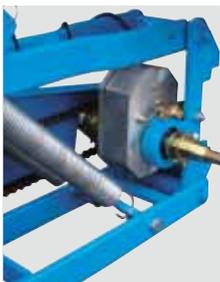
Электромагнитная муфта на секции NG Plus 4
