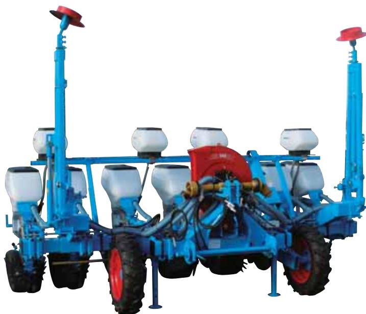
Сеялка с фронтальными колесными блоками для посева с уменьшенным междурядьем (До 37,5 см)
