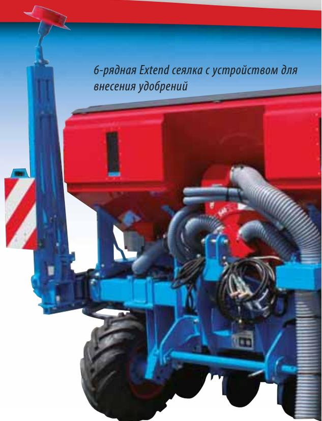
6-рядная Extend сеялка с устройством для внесения удобрений
