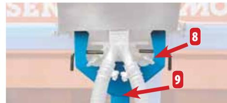
Емкость бункеров для Microsem 20л. В опциях доступны также бункеры 40л (устанавливаются в зависимости от рамы). Заслонка (8) и желоб (9) позволяют легко и быстро очистить бункер от оставшегося продукта.
