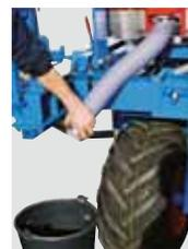
Бункер « Большой Емкости » для 6-рядной и Extend сеялок оборудован выгрузной заслонкой с каждой стороны со шлангом для быстрого опустошения бункера.
