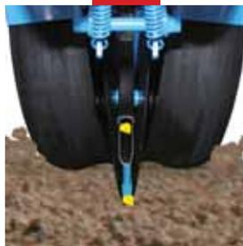
Изогнутый семяпровод, специально разработанной формы, мягко закладывает семена, обеспечивая совершенную равномерность.
