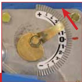
Для больших семян всасывание максимально и селектор приспособлен согласно размеру семян.
