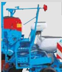
На сеялках Monoblock2 Comfort с устройством для внесения удобрений, платформа, поставляется в стандартной комплектации, она обеспечивает простой доступ к бункеру для удобрений во время загрузки.
