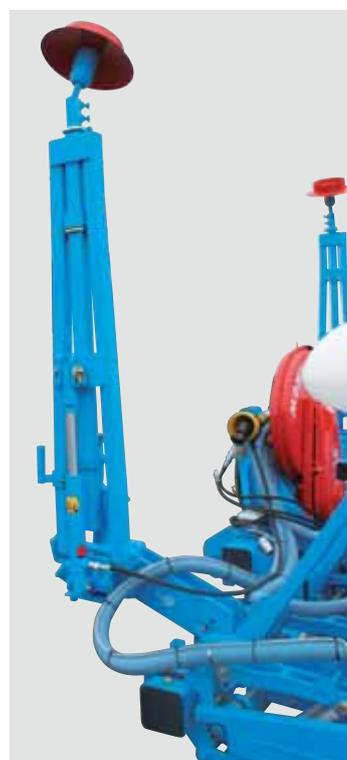
Маркеры ряда устанавливаются на главной балке рамы для ограничения нагрузки на выдвигающихся балках (Моноблок 125).
