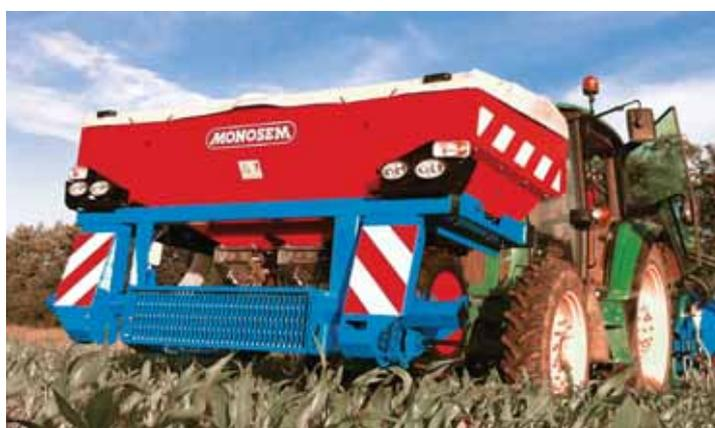
Передний навесной бункер DUO доступен с емкостью 1500 л или 2100 л. Может устанавливаться на сеялках NG Plus 4 с 12-рядами. Такие бункеры имеют двойную систему распределения из нержавеющей стали и раздаточную коробку с рычагом для быстрой регулировки нормы внесения.
