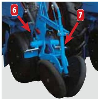
Желоб (6) системы Microsem для инсектицидов расположен между 2 дисками для подачи продукта в рядок. Желоб (7) системы Microsem для гербицидов устанавливается для внесения продуктов в рядок до или после прохождения прикатывающих колес.
