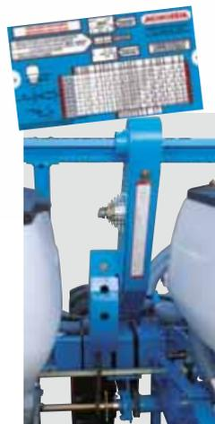
Настройка системы осуществляется использованием коробки с 18 соотношением. Если необходимо, доступны другие звездочки и также быстрая система отключения. Таблица настройки, поставляемая с системой Microsem позволяет осуществить быструю настройку нормы внесения продукта. Как стандарт система Microsem для инсектицидов дает норму внесения от 3 до 25 кг/га и от 3 до 10 кг/га для гербицидов при посеве с междурядьем 75 см.
