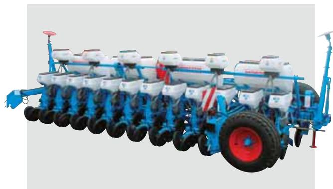
12-рядная сеялка с жесткой Двойной балкой (45 см междурядье) с продольной транспортной тележкой.
