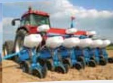
Многофункциональная пневматическая сеялка NG Plus 4 с дисковым сошником
