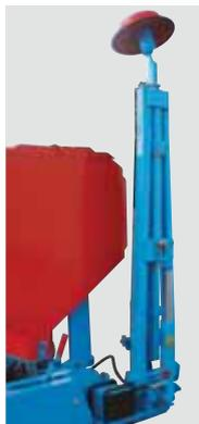
Гидравлический рядный маркер стандартное оборудование на всех сеялках.
