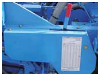
Привод высевальной секции обеспечивается укрепленной коробкой. Раздаточная коробка расположена с левого края сеялки для легкого доступа и быстрой смены звездочек. 20 возможных комбинаций со сменными звездочками дают широкий диапазон плотности высева.
