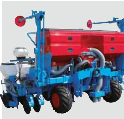
Бункеры «Высокой Емкости » из листового металла на одинарной или двойной телескопической раме, Monoblock2 Comfort, имеют емкость 680 л или 1030 л. На рамах Extend, емкость 1020 л. Емкость 1500 л имеют бункеры на складных рамах TFC.
