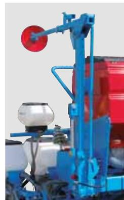
Складные маркеры ряда позволяют делать метку по колесу или по центру, но немного увеличивают ширину в транспортном положении. Они также оборудованы защитной системой и механическим запорным устройством для транспортировки.
