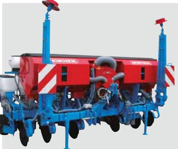
Бункер « Большой емкости » из листового металла на Моноблоке, с одинарной или двойной телескопической рамой имеет емкость 900 л.
