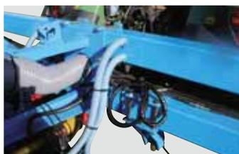
Двойная балка 180 x 180 мм имеет объединенную систему всасывания.
