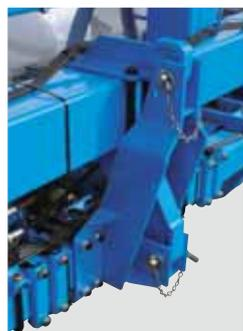
Установка секций сеялок на сдвоенных балках позволяет каждой секции копировать поверхность.
