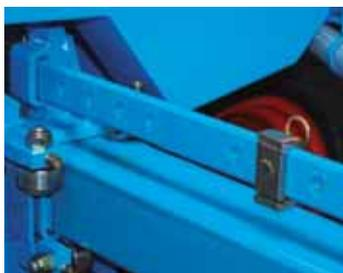
Установка междурядья на сеялке NG Plus 4 Extend очень проста. Вы просто помещаете стопора на регулируемой балке на нужных интервалах и затем просто удлиняете или сокращаете шток цилиндра в телескопических балках, чтобы получить желаемое междурядье.
